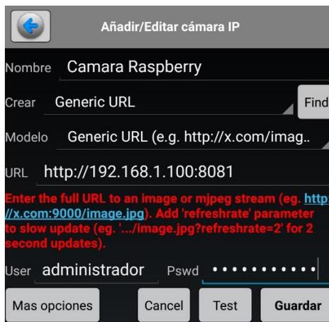
Pulsaremos sobre el botón test para comprobar la conexión con nuestra cámara de videovigilancia, debiendo obtener un mensaje de confirmación de la conexión. Para finalizar si volvemos a la página principal de la aplicación comprobaremos como obtenemos a la perfección la imagen de la cámara de seguridad:
